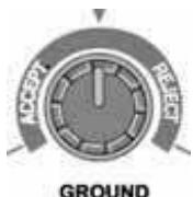
С помощью этого регулятора Вы можете подкорректировать влияние земли и более точно отсечь железосодержащие минералы или любые другие остатки керамики, содержащие окислы железа.
