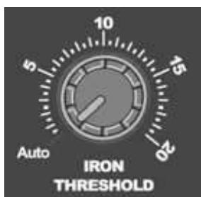
XP Gold Maxx Power является «многотональным» детектором, но пользователи могут произвести настройку тона железа, используя регулятор IRON THRESHOLD (Пороговый тон железа).
