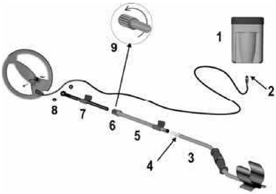
1. Соедините две части штанги (3) и (5) таким образом, чтобы пружинный зажим (4) зафиксировал их.
