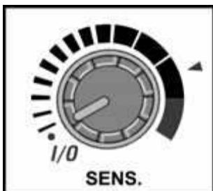
Включите свой металлоискатель, повернув регулятор SENSITIVITY I/O (Старт Вкл./Выкл., Чувствительность). Вы услышите несколько быстрых сигналов, которые сообщают Вам, что металлоискатель корректно работает.
