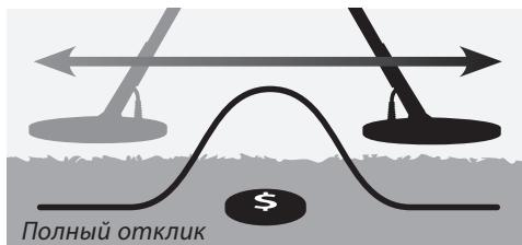
Активируйте режим точного определения размера цели, когда цель находится рядом с катушкой, это позволит сделать сигнал от цели более точным, за счет экранирования части сигнала. При этом Вы добиваетесь эффекта как при использовании автоматического режима определения положения цели, но Вы сами контролируете экранирование отклика от цели. Помните, что если Вы активируете режим Точного определения размера цели прямо над ней, то можете полностью экранировать отклик от цели.
