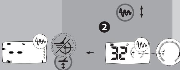
! В режиме точного определения отслеживание баланса грунта автоматически выключается, а включается после возврата к поиску.
