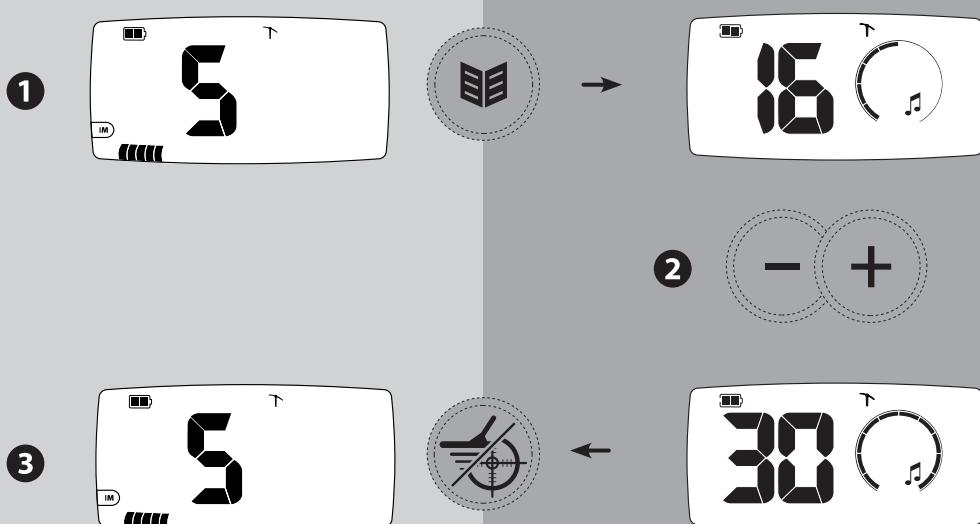
металлоискатель X-Terra 705 может работать на двух разных типах почвы: магнитоактивной (например, на территории, удаленной от морей и океанов и на золотых приисках) и токопроводящей (влажные участки пляжей морей и океанов) Минерализация земли может вызывать ложные сигналы. При правильной настройке на грунт количество ложных сигналов уменьшается, а настоящие цели отображаются корректно, с нормальным звуком
