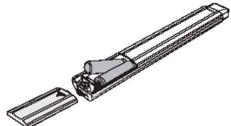
Высококачественные щелочные батарейки рекомендуются для достижения оптимального времени поиска. Перезаряжаемые щелочные, никель-металлогидридные или никель-кадмийевые аккумуляторные батареи могут использоваться, но должны быть вынуты и заряжаться отдельно. Проверяйте пригодность батарей перед их покупкой, так как некоторые не соответствуют стандартному размеру.
