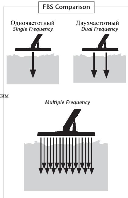
Схема широкополосного FBS-генератора автоматически излучает одновременно множество рабочих частот. Благодаря расширению области рабочих частот полученный от объекта сигнал анализируется с учетом многообразных откликов. Это позволяет «Сафари» анализировать большее количество информации о цели, что делает целевую идентификацию более точной.
