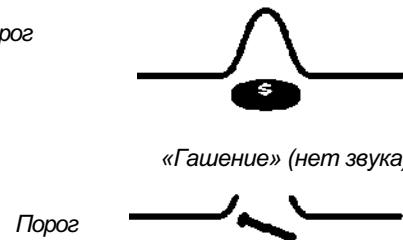
**Примечание:** При прохождении катушки над гвоздем звучание Порогового тона моментально гаснет.
