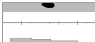
Тот же самый толстый ржавый железный болт, проверенный с другого направления, более ясно показывает, что он железный.
