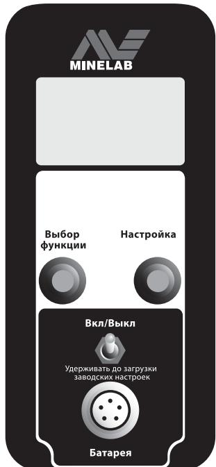
Переключатель «Вкл/Выкл» расположен на заднем пульте управления.
