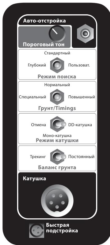
**Кнопка «Авто-отстройка»** (стр. 32) позволяет включить автоматическое сканирование диапазона частот с целью сведения к минимуму электрических помех.
