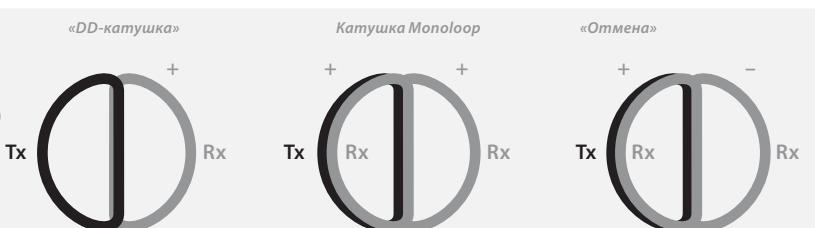
На рисунке показаны внутренние витки катушки. Видно различие характеристик приема в трех положениях переключателя «Режим катушки».
