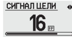
При **ВЫСОКОМ** значении функции «Пик сигнала» различие частот сигнала цели будет значительным. Однако на сильно минерализованном грунте это увеличивает слышимость помех.
