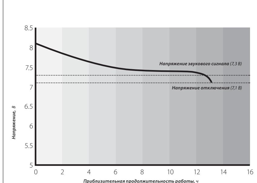
Преимуществом литий-ионных аккумуляторных батарей является их способность поддерживать первоначальное напряжение на протяжении большей части рабочего цикла (после чего напряжение резко падает и батарея требует зарядки).
