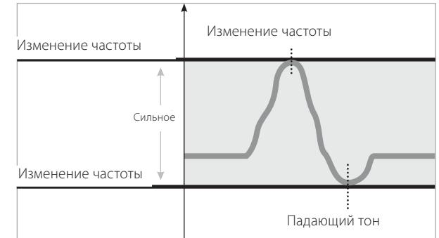
При **НИЗКОМ** значении функции «Пик сигнала» различие частот сигнала будет незначительным, т.е. сигнал будет более монотонным.
