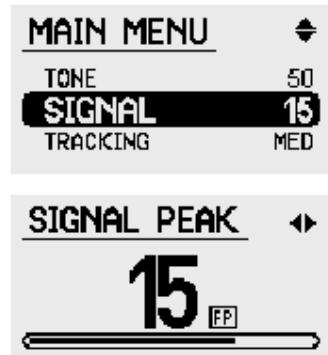
Настройка помогает отличать большие глубинные цели от небольших поверхностных по тону сигнала. Целевой сигнал на GPX-4500 двух тональный, но если вы захотите вы можете установить моно сигнал. Целевой сигнал, который сначала уменьшается и затем повышается, - обычно указывает на глубоко лежащую цель. Повышение и затем падения тона указывает на маленькую цель.
