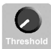
Постоянно слышимый звук в наушниках. Изменение характеристик порогового тона свидетельствует о наличии металлического объекта под катушкой прибора. Уровень громкости необходимо выставлять так, чтобы пользователь чувствовал себя комфортно. Если уровень громкости порогового тона установлен слишком низко или слишком высокой, маленькие целевые сигналы не будут различимы. (см.рис.).
