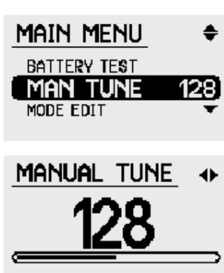
От электрических помех вы можете отстроить металлоискатель как в автоматическом режиме так и в ручном. Кнопка автоматической отстройки Auto Tune находится на задней панели управления. Если по каким то причинам автоматическая отстройка вам не понравилась или не хочется тратить время на ожидание вы можете вручную подстроить металлоискатель на менее шумный канал.
