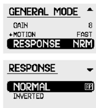
Эти настройки не влияют на глубину обнаружения или чувствительность металлоискателя, а предназначены только для удобства пользователя или личного предпочтения или привычки поисковика.
