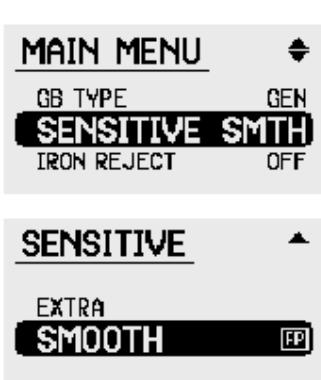
Переключатель на задней панели управления Soil/Timings (установка металлоискателя на различные типы почв и размер цели) в режиме Sensitive (чувствительная к мелким целям) имеет два дополнительных параметра доступные через меню Smooth и Extra.
