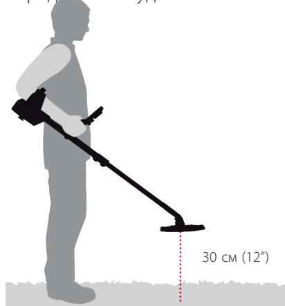
*Рисунок 17 – Правильное положение детектора для отстройки от помех*
