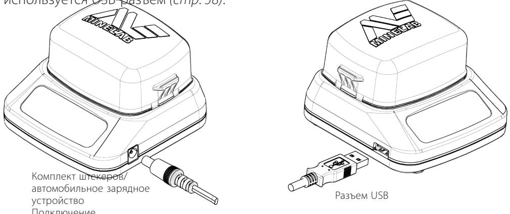
Рисунок 36 – Разъемы BC 10 для адаптера и USB
