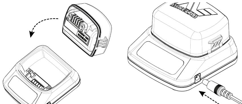
**Рисунок 39 – Перезарядка литий-ионного аккумулятора**
