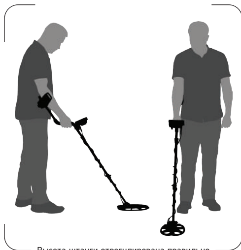
Высота штанги отрегулирована правильно
