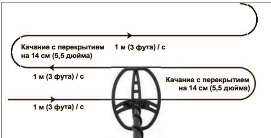
Чтобы полностью выполнить поиск в области, выполните перемещение поисковой катушки с перекрытием на половину длины катушки (около 14 см). Проводите поисковую катушку по прямой или с небольшой дугой со скоростью перемещения около 1 м / с.
