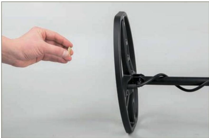
Для воздушных тестов поместите поисковую катушку на плоскую, стабильную, неметаллическую поверхность, которая находится, по меньшей мере, в метре от других металлических предметов.
