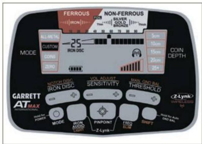
Примечание: Изменения, внесенные в шаблон меток дискриминации в режиме CUSTOM, будут сохраняться при отключении питания металлоискателя. Изменения, сделанные во всех других режимах, вернутся к заводским настройкам, когда металлоискатель выключен и снова включен.
