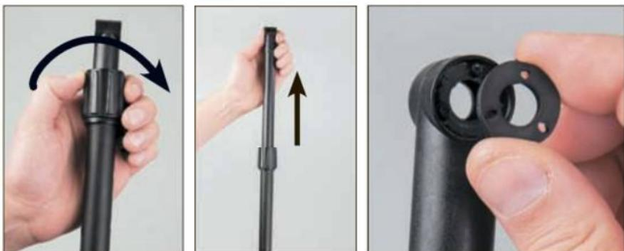
Подключите поисковую катушку к штанге, как показано на рисунке, и затяните руками баращковую гайку. Ослабьте верхний эксцентриковый зажим, нажмите на пружинный фиксатор в S-образной штанге и вставьте среднюю штангу в S-образную штангу. Затяните эксцентриковый фиксатор.
