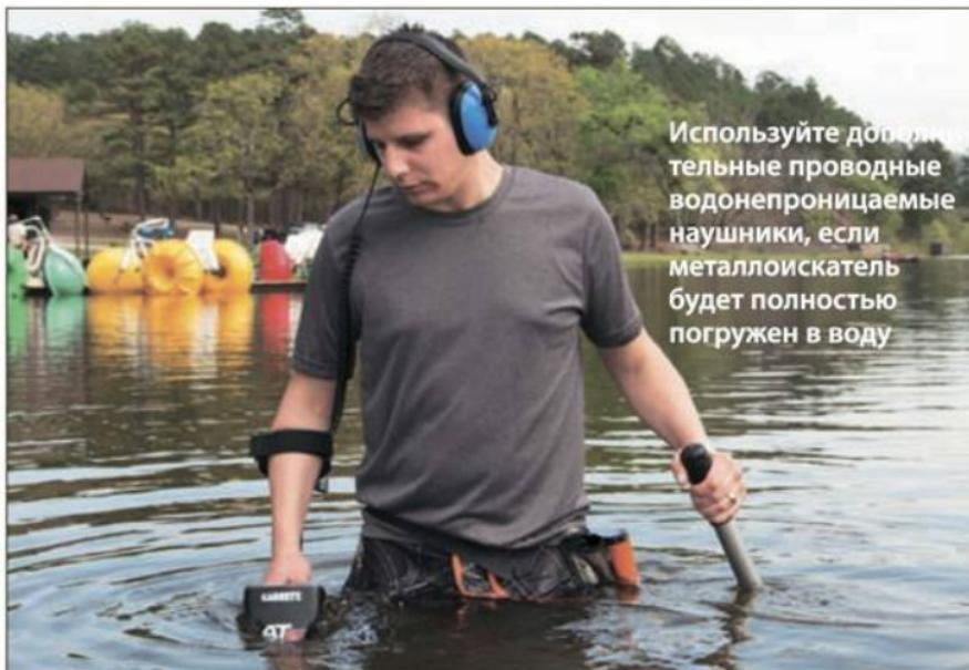
При использовании AT Max с беспроводными наушниками MS-3 не погружайте в воду блок управления металлоискателя. Должны использоваться водонепроницаемые наушники (продаются отдельно).
