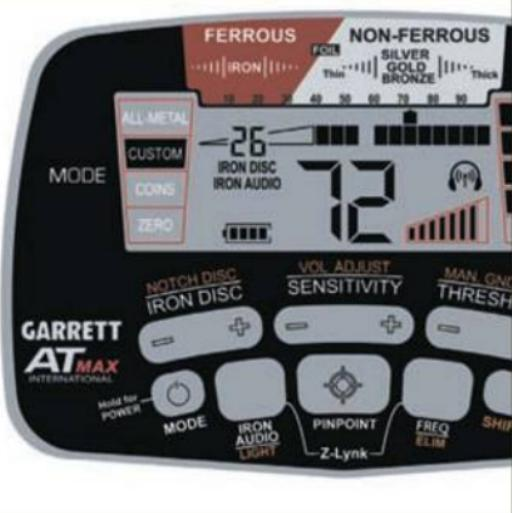
Нажмите и отпустите кнопку IRON AUDIO для включения / выключения функции Iron Audio. Когда эта функция включена, слова «IRON AUDIO» появляются на ЖК-дисплее (как показано на рисунке выше). Функция Iron Audio может использоваться в любом из четырех режимов AT Max. Его функциональные возможности в трех режимах дискриминации по сравнению с режимом All Metal будут обсуждаться отдельно.
