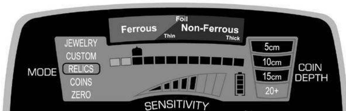
На рисунке сверху *EuroACE* работает в режиме RELICS, с двумя отключёнными пикселями дискриминации железа. Гвоздь, показанный на Рис. 1 на стр. 22, регистрируется над третьим пикселем. Эти железистые объекты могут быть исключены из нахождения при использовании кнопки  $\checkmark/\times$ , выключив третий слева пиксель.
