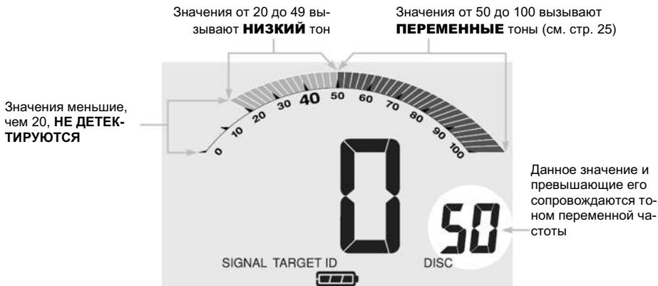
Этот интерфейс дискриминации для Gold Bug DP был разработан специально для поиска реликвий. Охотники за реликвиями предпочитают держать под контролем размер железных объектов, на которые реагирует прибор, а также то, на какие объекты он реагирует низким тональным сигналом. Объекты с сигнатурой 40 и меньше сделаны из железа.
