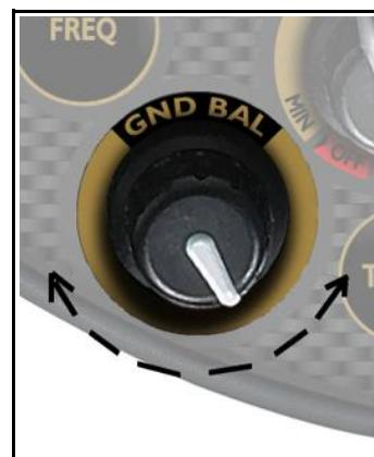
5. Повращайте ручку как по часовой, так и против часовой стрелки, когда двигаете катушку вверх-вниз, и отметьте положение ручки, при котором звук меняется с *отрицательного ответа на положительный*.
