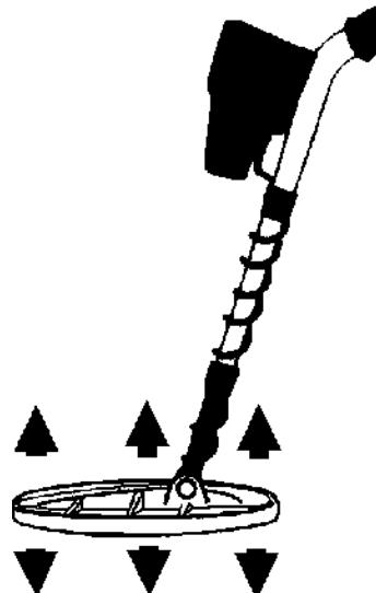
**Внимание:** если вы заметили ложные сигналы высокого тона в режиме DISCRIMINATION, параметр отстройки от грунта слишком *положительный*; для решения этой проблемы вам необходимо повернуть ручку против часовой стрелки.
