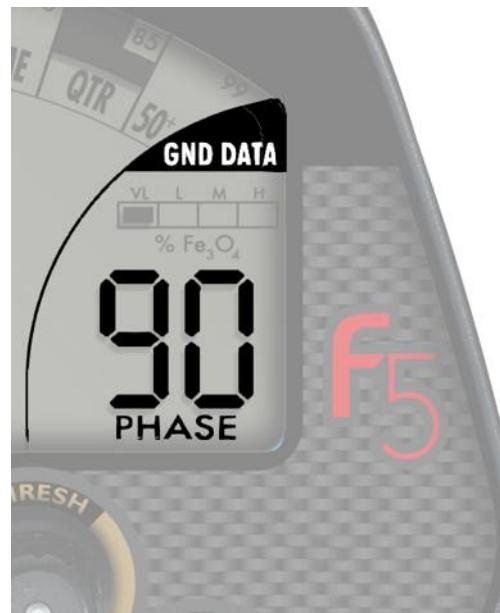
Для отображения PHASE необходимо, чтобы катушка находилась в движении. Наиболее достоверные значения достигаются при вертикальных движениях катушки вверх-вниз над поверхностью почвы. Присутствие в почве металлов или «горячих камней» может привести к ошибочным результатам. Когда движение катушки прекращается, значение PHASE принимает абстрактное значение, либо отсутствует.
