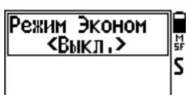
Особенностью этого режима является переход прибора на низкое потребление электроэнергии за счет снижения тока возбуждения ВТП. При этом наработка детектора может доходить до 40 часов (для АКБ 2800 мА/ч). Кроме того данный режим позволяет более достоверно осуществлять балансировку прибора по грунту при работе на высокоминерализованных морских пляжах. Режим можно рекомендовать при работе на замусоренных участках, где не требуется высокая чувствительность.
