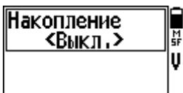
При выбранном режиме накопления «выкл» на экране будет виден лишь один годограф от последней идентифицированной прибором цели. При идентификации следующей цели предыдущий годограф стирается. В режиме «2», «3» на экране так же сохраняются годографы
