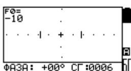
В предыдущих моделях линейки числовой результат (в градусах) этого поворота и являлся эквивалентом уровня БГ, что отражалось в нижней левой части экрана поле звуковой индикации.
