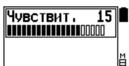
Данная опция позволяет проводить регулировку чувствительности Вашего прибора. Вы можете изменить её значение от 0 до 21. Помните, с увеличением чувствительности прибора не только возрастает глубина поиска, но и повышается возможность появления помех от линий электропередач и ложных срабатываний при ударах катушкой о препятствия. Выбирайте оптимальную чувствительность на месте поиска, исходя из формулы «наивысшее значение, возможное для стабильной работы прибора в данном месте».
