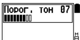
Данная опция позволяет проводить регулировку чувствительности (глубины обнаружения) порогового тона Вашего прибора. Пороговый тон - это сигнал канала обнаружения, дающий Вам информацию о том, что прибор обнаружил металлический предмет. С момента обнаружения и по ходу движения катушки громкость порогового тона возрастает, имея наивысшее значение над центром цели.
