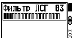
Опция позволяет выбрать уровень подавления ложных сигналов обусловленных повышенной электропроводностью грунта (засоленные почвы, морской пляж и т.д.).
